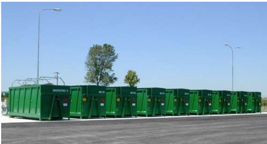
Εικόνα 36 Διάταξη-Σύστημα φορητών βιοαντιδραστήρων
